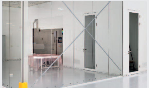
De vacuümkamer waarin straks de restgas-analyses gaan plaatsvinden.
